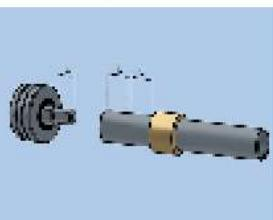
**5** Надвинуть пильзун на фитинг до упора с помощью ручного или гидравлического пресса. В процессе напрессовки инструмент держать под прямым углом, избегая перекосы фитинга и пильзы в губках пресса и относительно друг друга. В случае использования коротких гильз, см. обратную сторону инструкции.
