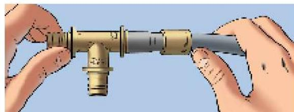
**2** Надеть пильзун на трубу фаской в сторону присоединяемого фитинга. Соединение следует монтировать на прямом участке трубы (без изгибов) минимальной длиной, равной трёх гильзам. При расширении трубы гильза должна находиться на расстоянии от края трубы, равном длине минимум двух гильз.
